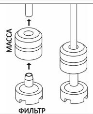
Перед тем, как вставить трубы в резервуары, закрепить на концах груз (необходимый для удержания трубы подачи на дне) и фильтр как указано на картинке. Если дозатор моющего средства не установлен изначально, его можно установить заказав соответствующий набор деталей.
