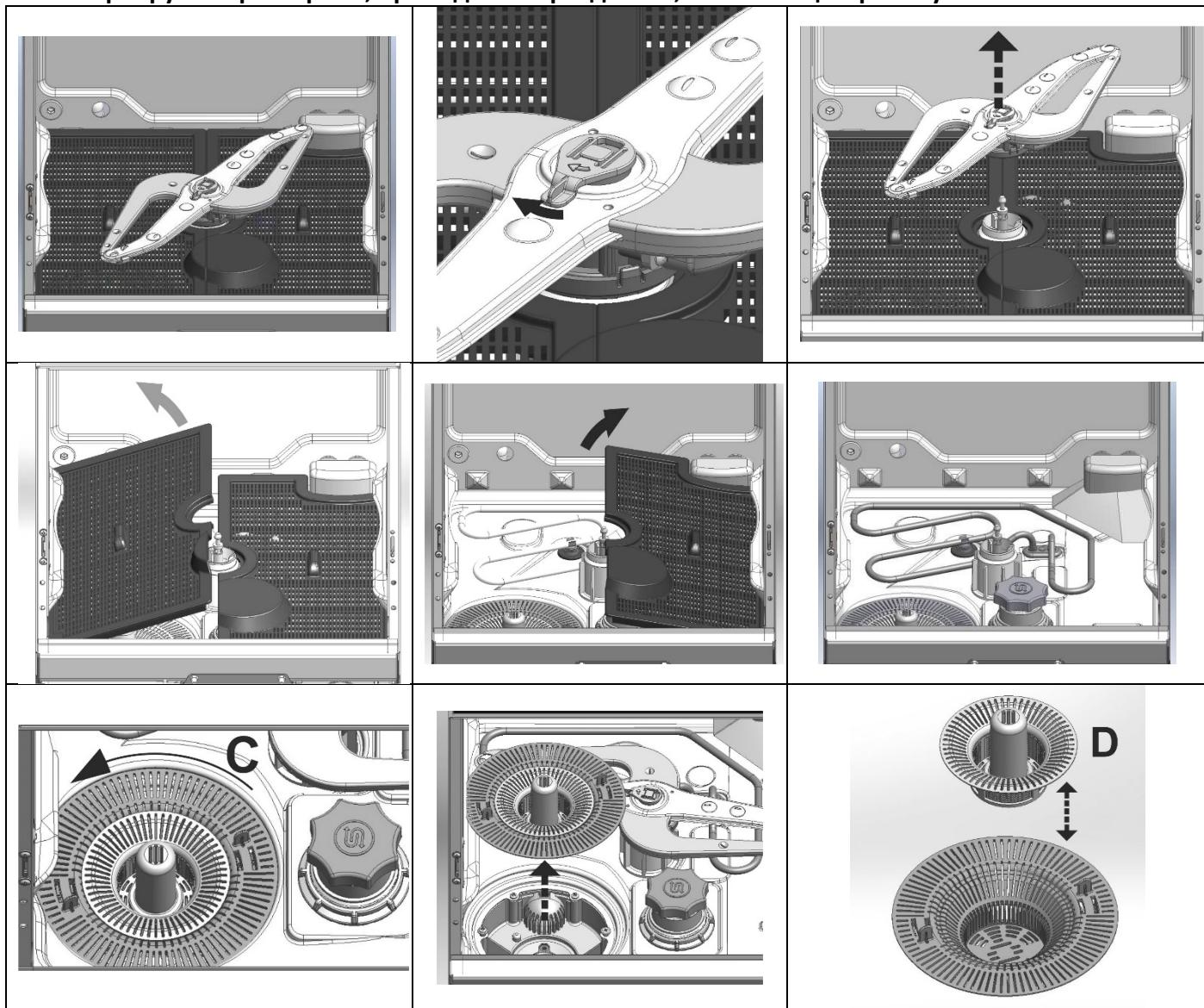
Процедура демонитрования фильтров с двумя фильтрующими элементами:
