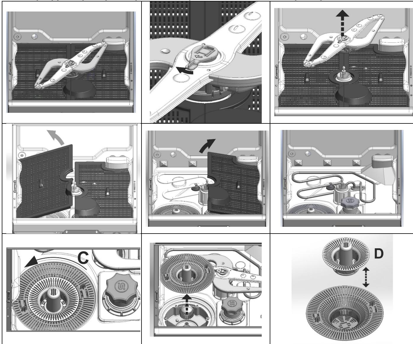
Процедура демонитрования фильтров с двумя фильтрующими элементами:
