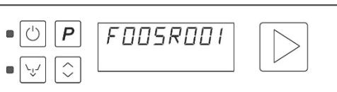
Если машина уже под напряжением, то при нажатии кнопки ВКЛ./ВЫКЛ. сразу отобразится установленная версия и ревизия прошивки.
