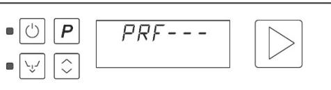
При включении электрической панели на дисплей выводится тип посудомоечной машины (PRF 400, PRF 500, CAPOTE.....), а следом за ним - установленная версия и ревизия прошивки.
