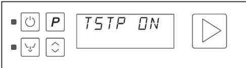
**При настройке на "вкл." = минимальная температура ополаскивания** соответствует настроенной (см. температуру бойлера выше), вне зависимости от температуры поступающей воды; номинальная продолжительность цикла может увеличиваться на несколько секунд.
