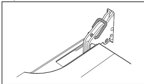
2. Взять дверцу за обе стороны двумя руками рядом с петлями, приподнять ее под углом приблизительно 30° и вынуть.
