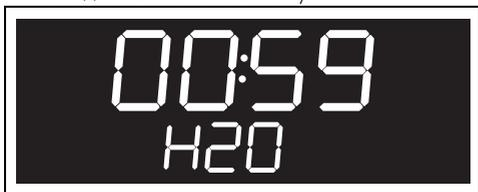
После завершения режима прибор издает акустический сигнал и на дисплее появится запрос на слив воды из резервуара.
