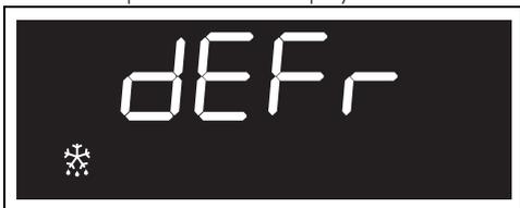
3. Нажмите на ручку регулировки температуры, чтобы подтвердить запуск функции.
