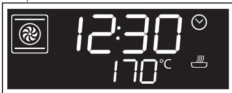
Приготовлению предшествует фаза предварительного разогрева, во время которой духовка быстрее достигает нужной температуры.
