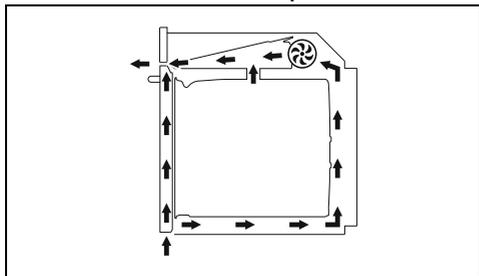
Вентилятор отвечает за охлаждение прибора и включается во время приготовления.
