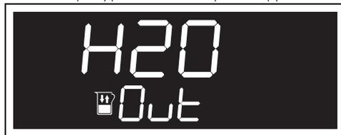
Вода начнет вытекать в глубокий противень из сливной трубки, расположенной на правой стороне задней стенки рабочей камеры.
