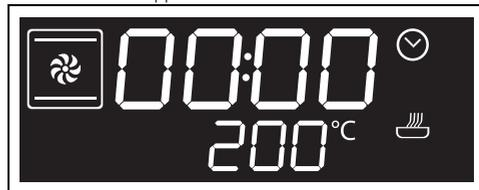
2. В течение 3 секунд поверните ручку регулировки температуры, чтобы изменить температуру
