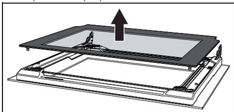
5. Потяните промежуточный стеклопакет в направлении нижней части дверцы, а затем поднимите его.
