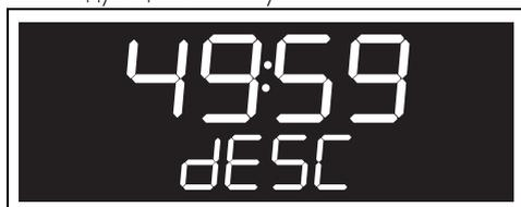
После завершения процесса удаления накипи прибор издает звуковой сигнал, а на дисплее отображается запрос на слив раствора для удаления накипи.
